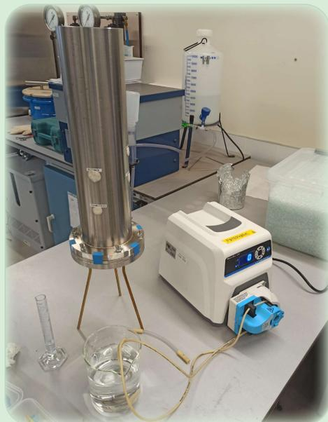
Las muestras de suelo tomadas de la parcela se tamizarán y se emplearán para realizar ensayos en columnas, evaluándose la capacidad del suelo para atenuar contaminantes de las aguas residuales.
